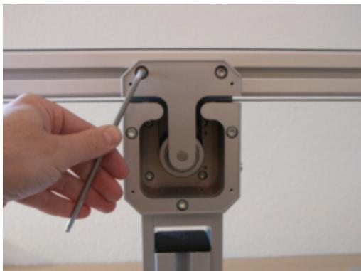
Lösen Sie die zwei Befestigungsschrauben für den Antriebs-Block.
