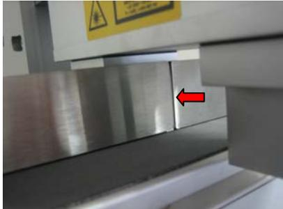
Bei Bedarf muß der Kameraschlitz durch „Durchziehen“ eines Tuches gereinigt werden.
