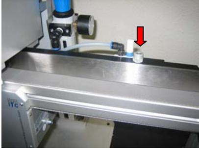
Wird die Schraube der Abluft-Drossel nach rechts gedreht, verringert sich der Luftdruck an den Ausblasdüse, wird sie nach links gedreht, so verstärkt sich der Luftdruck.
