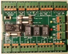
Die Klemmenplatine wird bereits vorverdrahtet ausgeliefert. Die unterschiedlichen Kabel sind bezeichnet und müssen an den entsprechenden Steckern / Buchsen des Förderbandes, der Kamera und zusätzlichen elektr. Komponenten angeschlossen werden.
