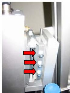
Um die Kamera in y-Richtung zu verschieben, müssen die drei seitlichen Schrauben gelöst werden, die Kamera kann anhand des Bildes der Grauwertzeile in CheckKon justiert werden und danach müssen die Schrauben wieder angezogen werden.
