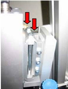
Um die Kamera in x-Richtung zu verschieben, müssen die zwei oberen Schrauben gelöst werden, die Kamera kann anhand des Bildes der Grauwertzeile in CheckKon justiert werden und danach müssen die Schrauben wieder angezogen werden.
