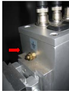
Zum Anschluß des Erdungsanschlusses an dem Förderband und an der Kamera muß ein Erdungskabel mit einem Mindestquerschnitt von 4 mm<sup>2</sup> verwendet werden. Das Erdungskabel muß hierbei mit dem Erdungsanschluß der Speisung verbunden werden. Es sollte so kurz wie möglich ausgelegt werden.
